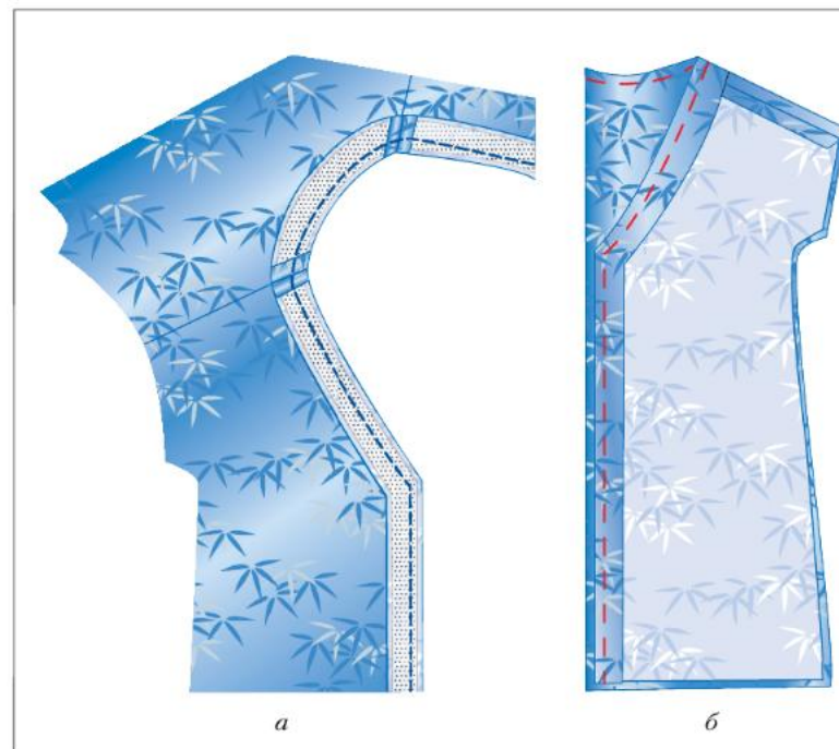
Рис. 66. Обработка горловины и застёжки подбортом: а – обтачивание подбортом; б – выметывание края
