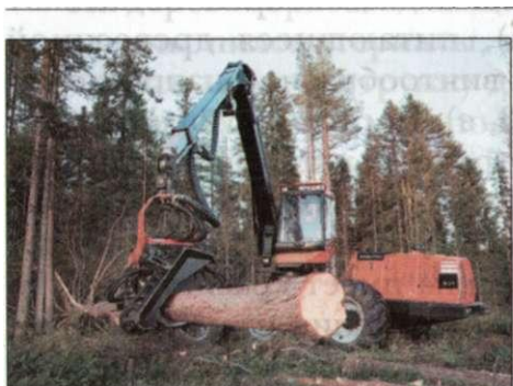
Рис. 1. Лесозаготовительный комбайн т-ми* (харвестер)
