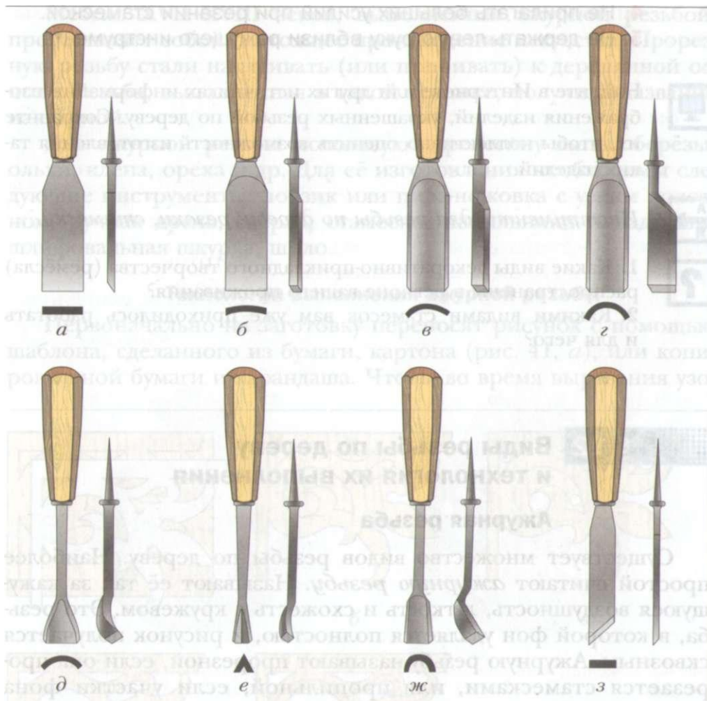
Рис. 39. Стамески для резьбы по дереву: а – прямая; б, в – отлогие; г – полукруглая; д – клюкарза; е – уголок; ж – царзик; з – косая
