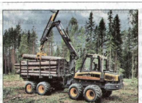
Рис. 2. Транспортирующая машина -нашив (форвардер)
