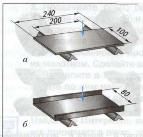
Рис. 60. Схема нагрузки полосок из жести (к пп. 5, 6)
