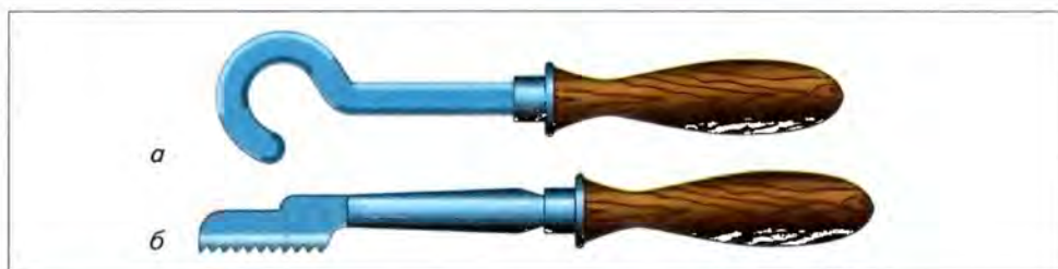
Рис. 39. Инструменты для точения художественных изделий: а — крючок; б — гребенка
