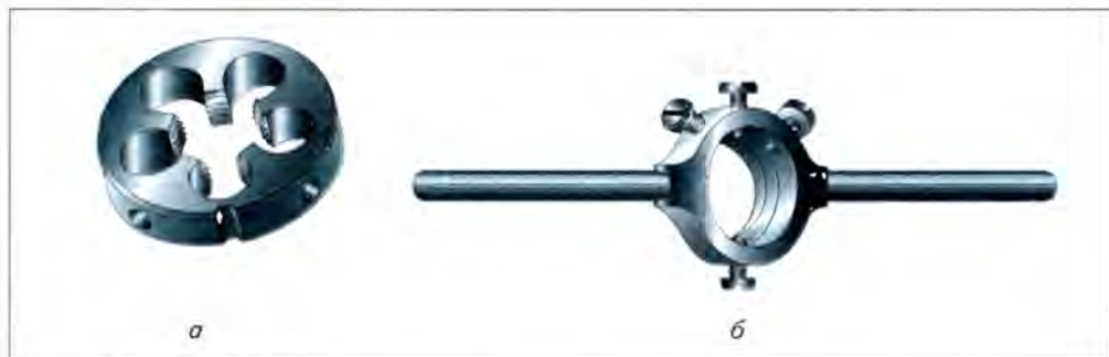
Рис. 79. Круглая плашка (а) и плашкодержатель (б)
