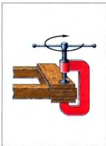
Рис. 29. Зажим шипового соединения при склеивании
